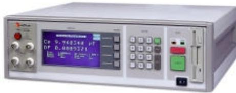
Figure 26: 7400 Precision LCR Meter
